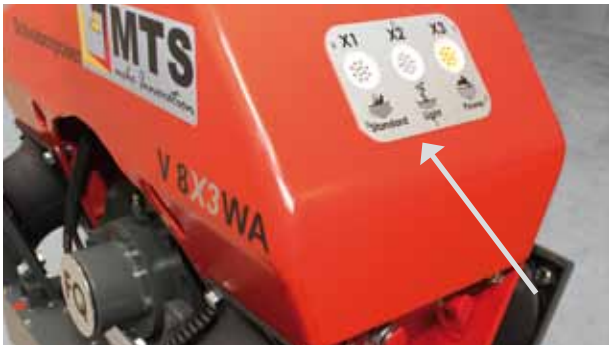
Eine LED leuchtet, wenn die entsprechende Frequenz erreicht ist.
