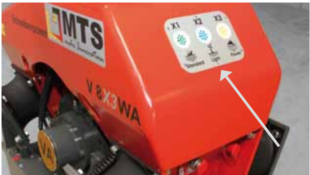
ALLE LEDs blinken, wenn das Ende der Verdichtung erreicht ist.
